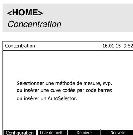
L'insertion d'une cuve à code barres déclenche directement la mesure.
