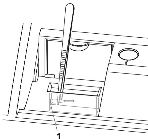
La lentille de détecteur se trouve sur le côté frontal gauche du puits de cuve rectangulaire (pos. 1).
